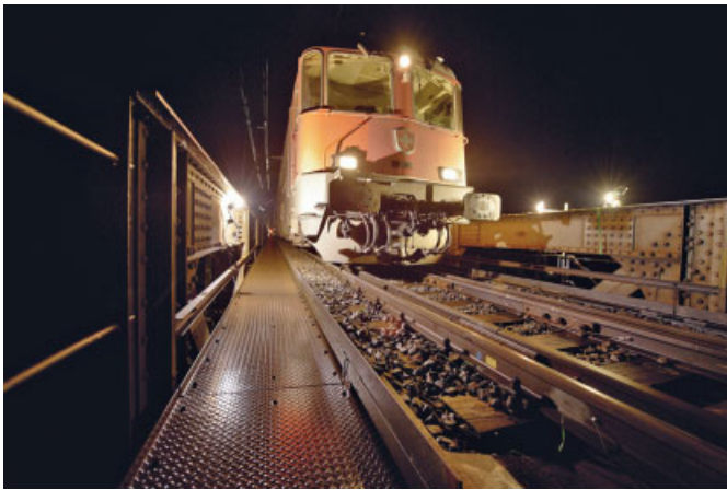
Bild 7. Lokomotivzug auf Lastposition 10 während der Belastungsversuche
