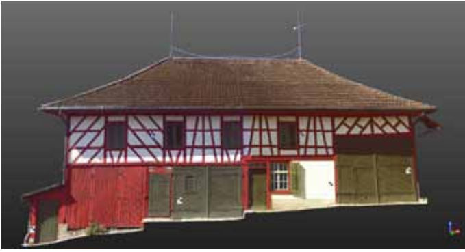
Architekturvermessung mit 3D-Laserscanning.
