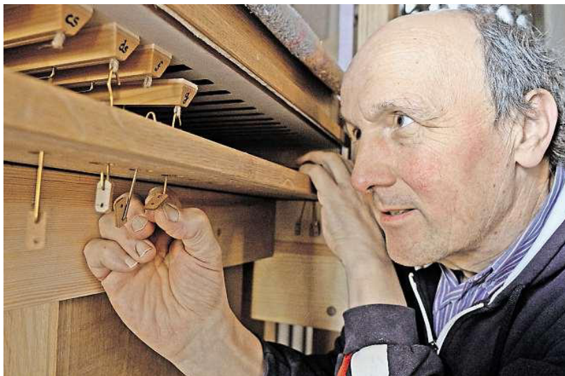
Felix Jenny baut mit viel Fingerspitzengefühl die handgearbeiteten flintigen Ventile ein. Bild: Martin Allemann
